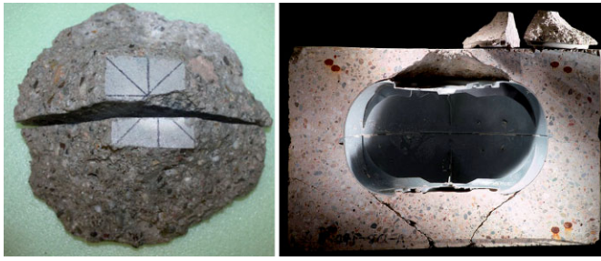
Fig. 9 Punching cone and sawed testing specimen after loading on top and bottom Ausbruchkegel und aufgeschnittener Versuchskörper nach einer Belastung auf der Ober- und Unterseite
