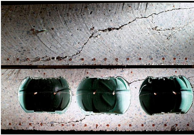
Fig. 7 Sheared off specimens in the "Bridge" and in hollow body axis after the failure (void formers high 220 mm) Aufgesägter Versuchskörper im „Steg“ und in Hohlkörperachse nach dem Versagen (Hohlkörperhöhe 220 mm)
